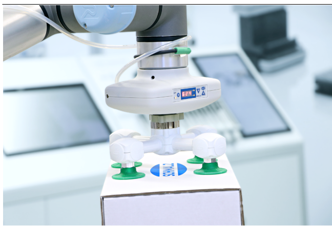
Generatore di vuoto pneumatico RECB per la movimentazione di scatole di cartone
